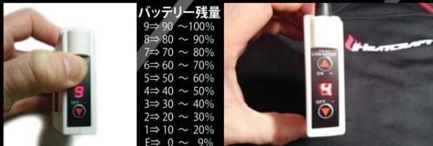
バッテリーに何も接続しない状態で(▲ON)マークのボタンを長押しすると、バッテリー残量がE (空)~9 (満)の数字で表示窓に表示されます。HeatCraftシャツから出ているケーブルのコネクタをバッテリーに繋げて下さい。
